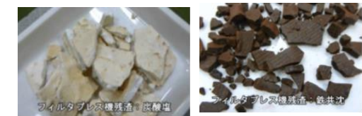
フィルタープレス方式による脱水前後における模擬スラリー
