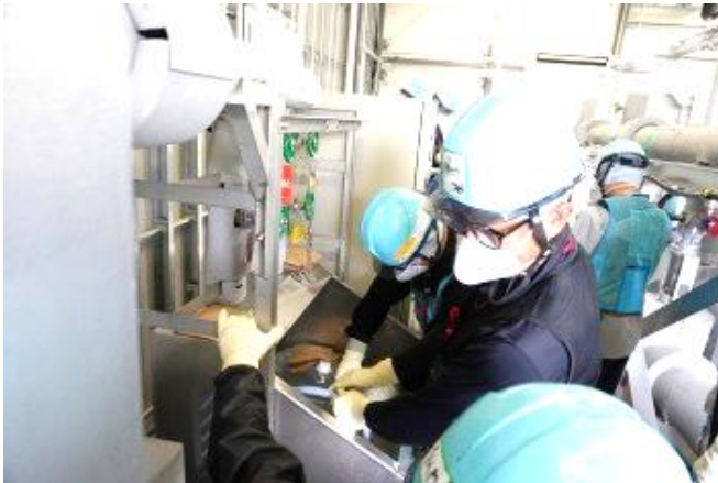
▼多核種移送設備建屋にてALPS処理水を採取している様子
