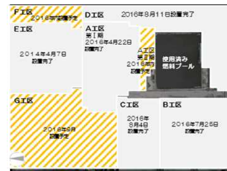
原子炉建屋真上からみた遮へい体設置状況
