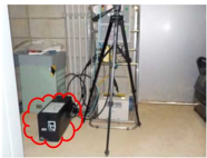
②結露対策 (サンプリングホース及び検出器への保温材取付) の状況
