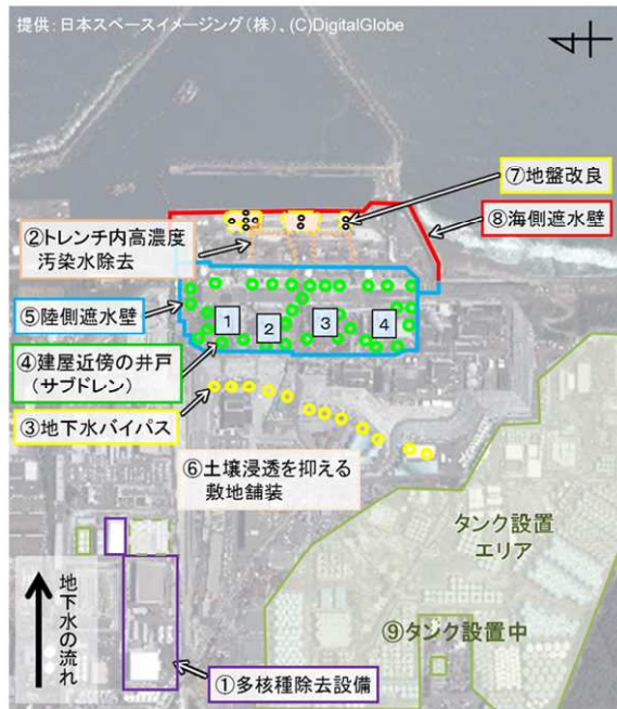
汚染水対策の概要図 (敷地平面図)
