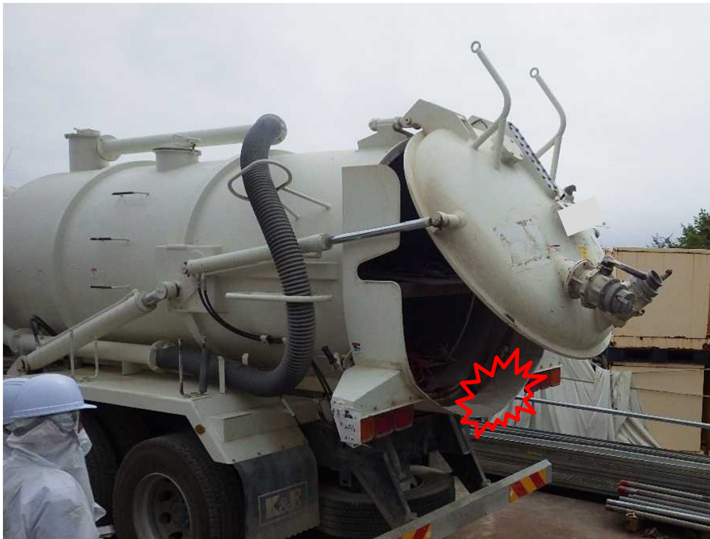
後部タンク蓋開閉動作の確認状況
