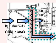
山側から流れてきた地下水を建屋の上流で揚水し、建屋内への地下水流入量を抑制する取組（地下水バイパス）を実施。くみ上げた地下水は一時的にタンクに貯留し、東京電力及び第三者機関により、運用目標未満であることを都度確認し、排水。揚水井、タンクの水質について、定期的にモニタリングを行い、適切に運用。建屋と同じ高さで設置した観測孔において地下水位の低下傾向を確認。建屋への地下水流入をこれまでのデータから評価し、減少傾向を確認。
