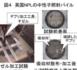
図6 非溶解性吸収材の燃料デブリへの投入・破碎試験
