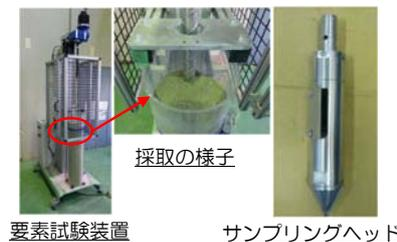
図3 セシウム吸着塔から使用済吸着材を採取するための採取試験装置とサンプリングヘッド
