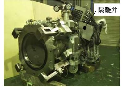
図1 X6ペネ接続構造（隔離弁付連結管）
