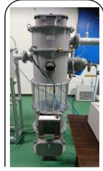
図3 気相前処理技術逆洗試験設備
