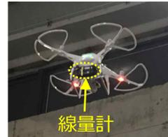
ドローンへの線量計設置状況
