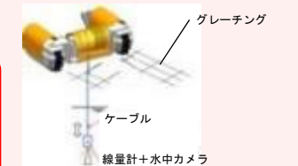
線量計、カメラ吊り降ろしイメージ
