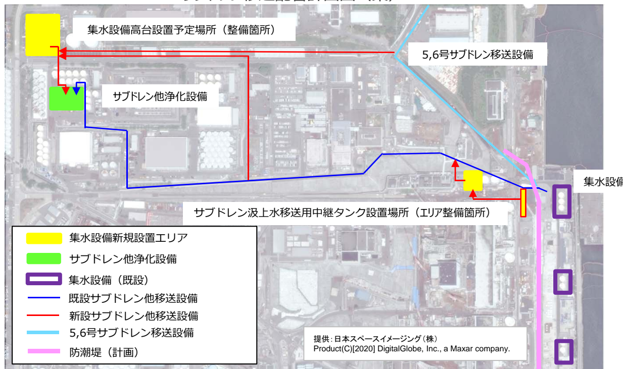
サブドレン移送配管計画図 (案)
