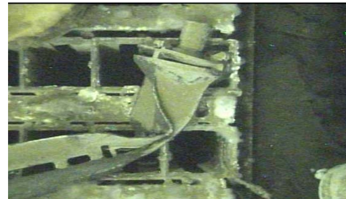
制御棒下部に変形
