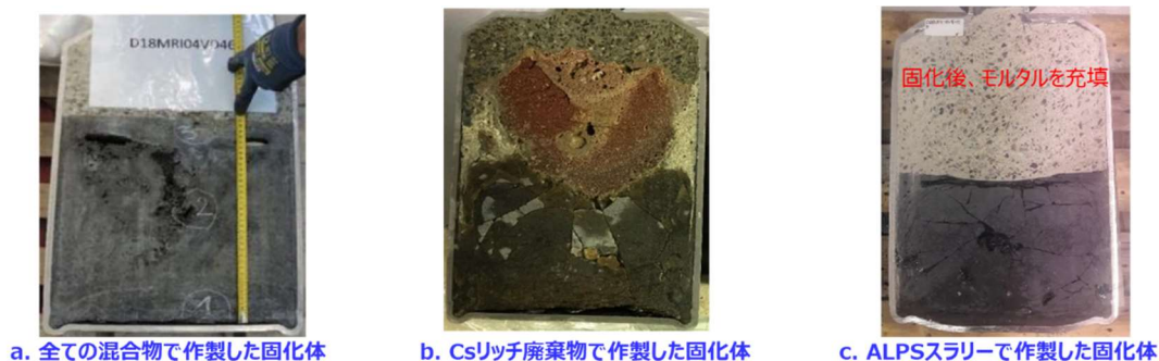
図 A11-17 In-Can 工学規模試験で作製した固化体の状況 152
