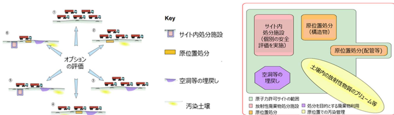
図 A11-2 原子力許可サイト内での検討可能な処分方策のオプション 138 （左）と サイト全体を対象とするセーフティケースの考え方 139 （右）
