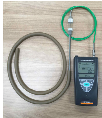
高濃度ガス検知器 （水素）
