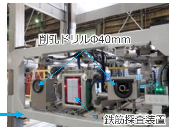
アンカー削孔機
