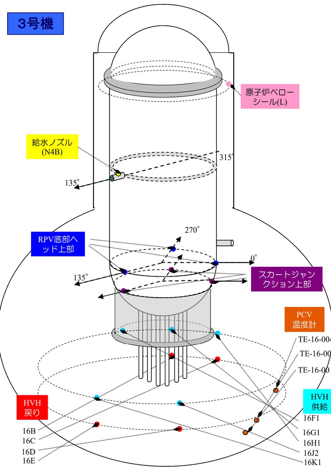
3号機 原子炉压力容器まわり温度(1/1~7/26)
