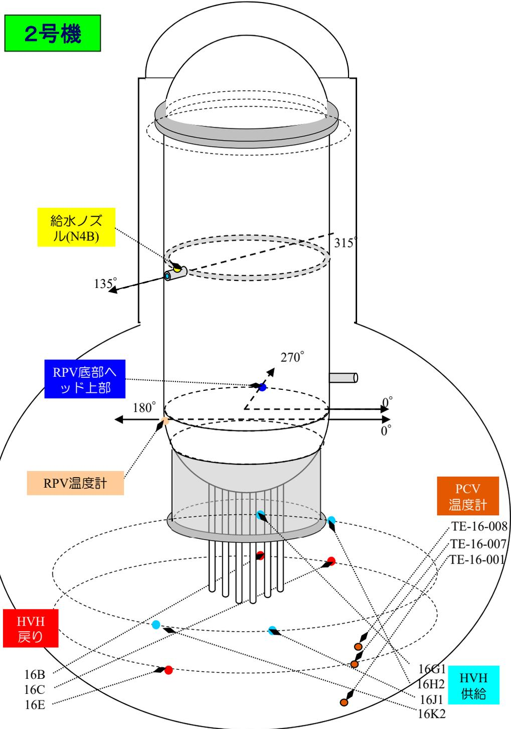
2号機 原子炉压力容器まわり温度(1/1~7/26)
