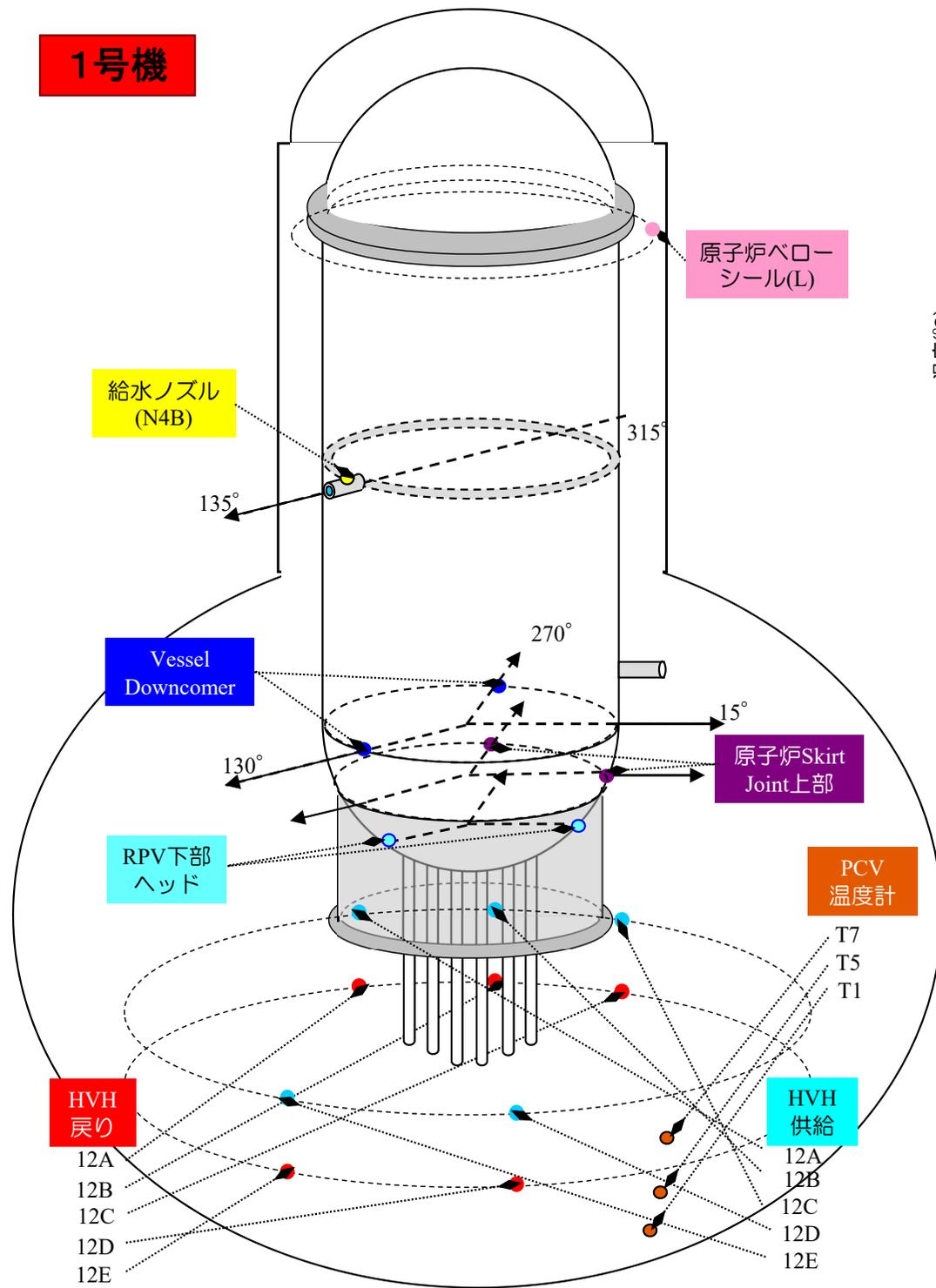
1号機 原子炉圧力容器まわり温度(1/1~7/26)
