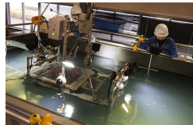
水槽で試験中のROV
