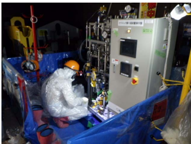
フィルタ通水試験装置写真
