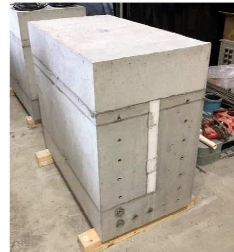
手順6：上部設置（試験体完成）
