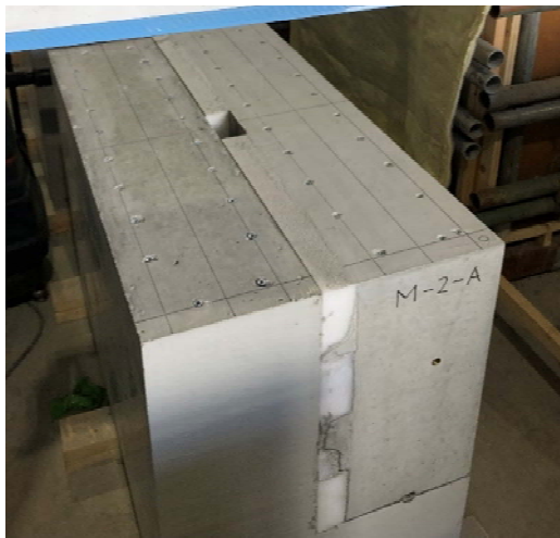
手順4：注入箇所除去
