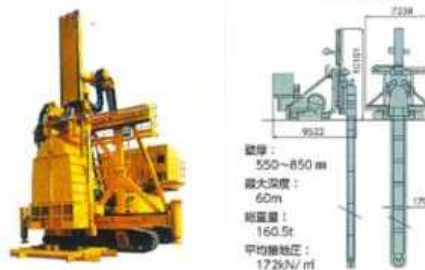
地盤改良(セメント改良土等)
