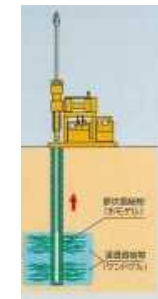
地盤注入(薬液等)
