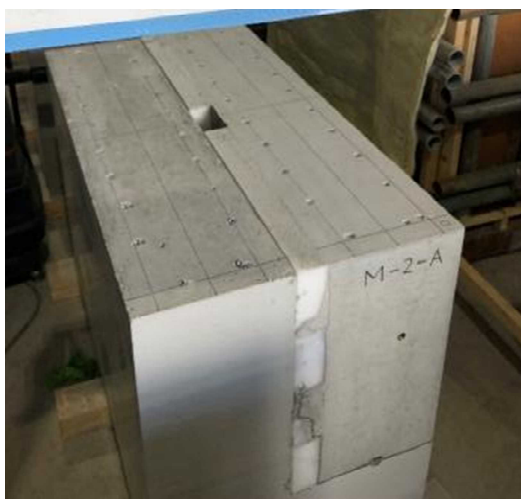
手順4：注入箇所除去
