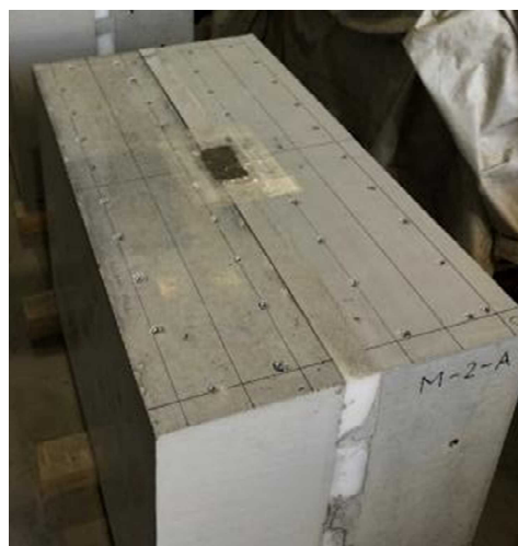
手順5：止水材（モルタル）注入完了
