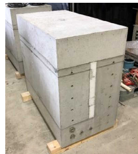
手順6：上部設置（試験体完成）
