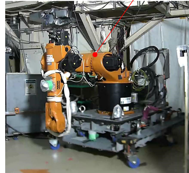
ハッチ開放装置搬入状況
