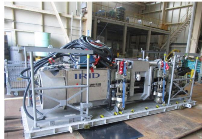
堆積物除去装置 (高圧水・AWJ) 外観
