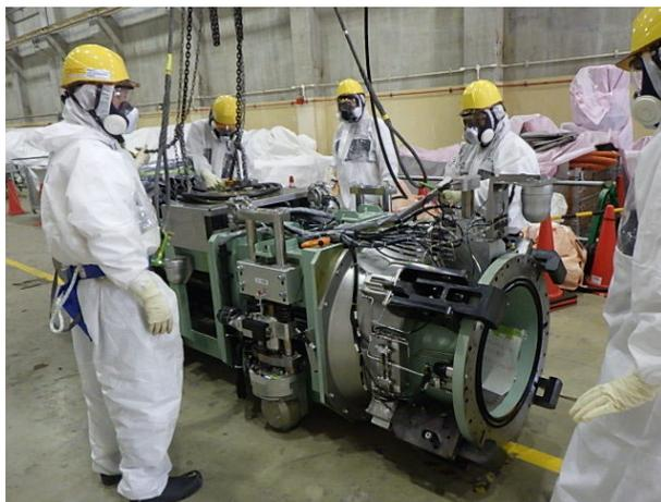
堆積物除去装置 (低圧水) 外観
