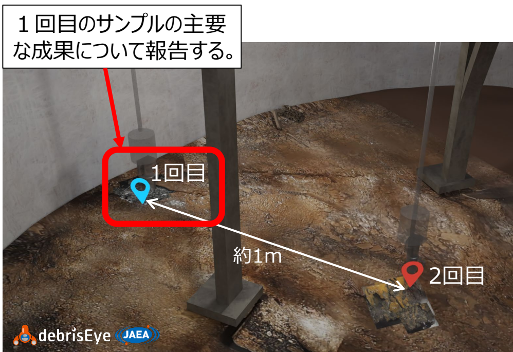
図 2 号機ペDESTAL内床面 燃料デブリの採取位置
