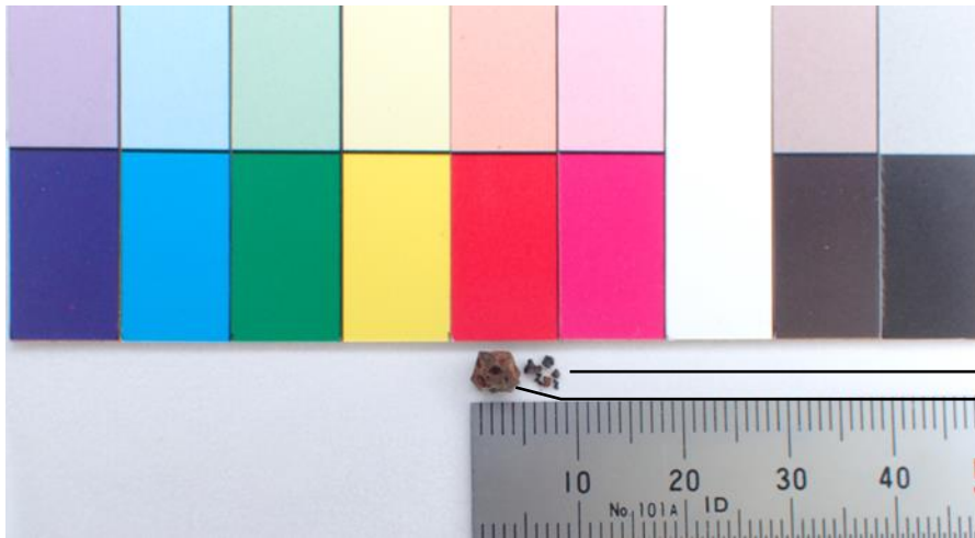
燃料デブリサンプルの外観 (色見本（カラーセパレーションガイド）、 スケール付)
