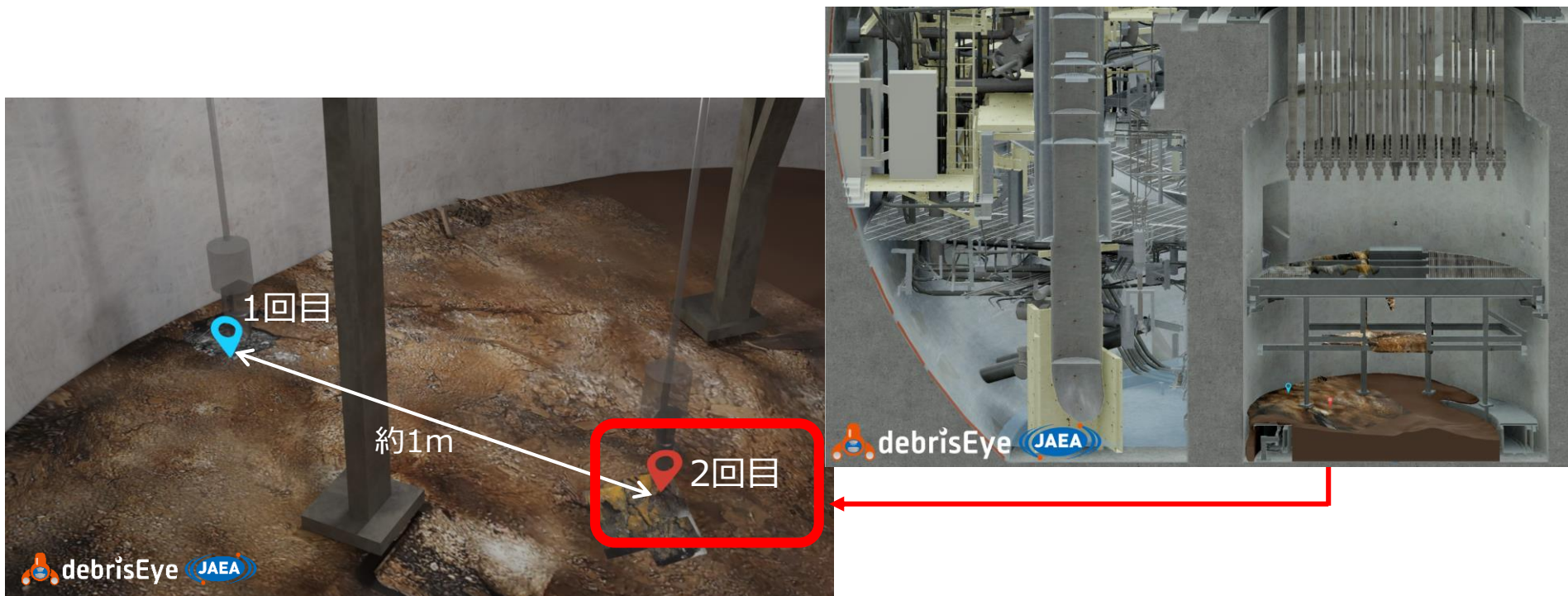
図 2号機ペDESTAL内床面 燃料デブリサンプルの採取位置
