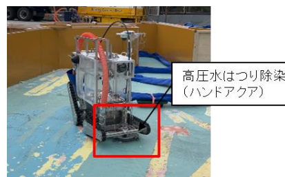
③高圧水はつり除染（床面）
