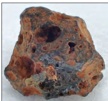
図 3.1-9 2 回目に採取した燃料デブリサンプルの外観
