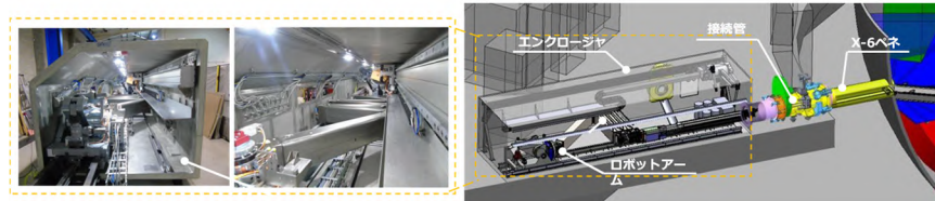
図 3.1-3 テレスコ式装置による燃料デブリ把持状況
