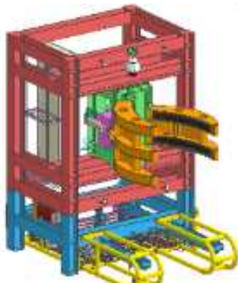
外周鉄骨切断装置 (屋根トラスにも活用)
