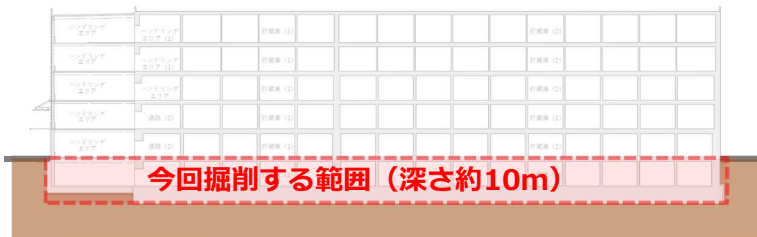
建築準備工事（山留・掘削工事等）イメージ
