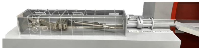
ロボットアームがエンクロージャに格納されている
