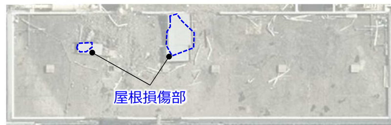
3号機タービン建屋・屋根状況【着手前】 〔上空から撮影〕
