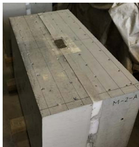
手順5：止水材（モルタル）注入完了
