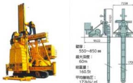
地盤改良(セメント改良土等)
