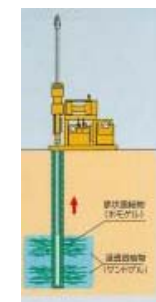
地盤注入(薬液等)
