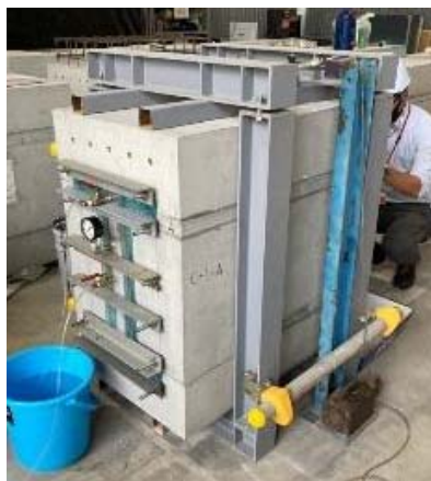
写真1 加圧試験状況
