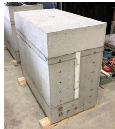
手順6：上部設置（試験体完成）
