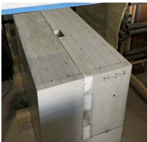
手順4：注入箇所除去
