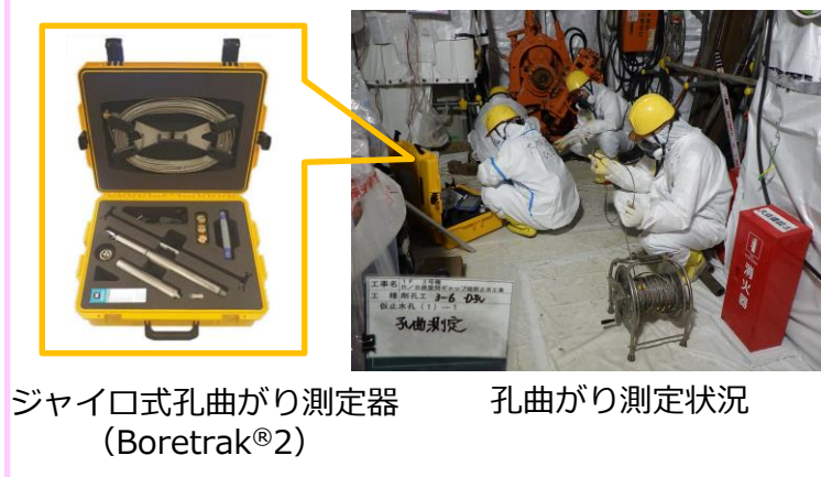
図2 孔曲がり測定、ビット交換の状況
