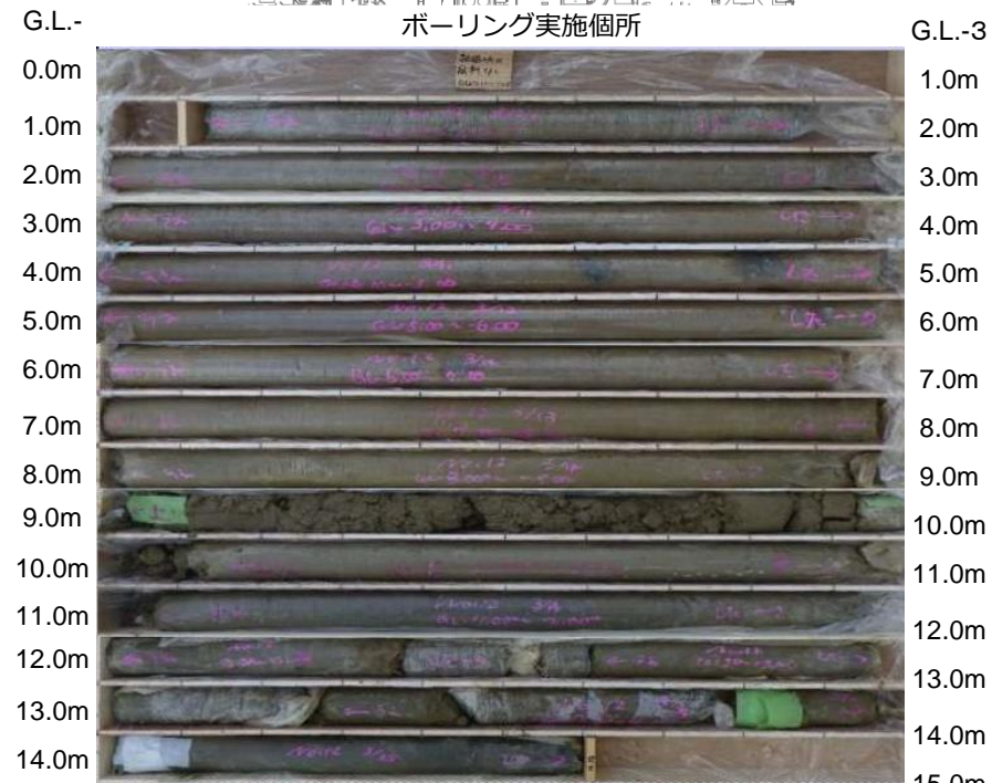
No.25-3-2 ボーリングコア
