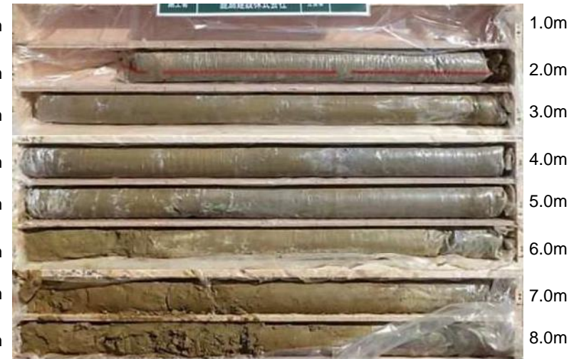
No.24-3-2 ボーリングコア
