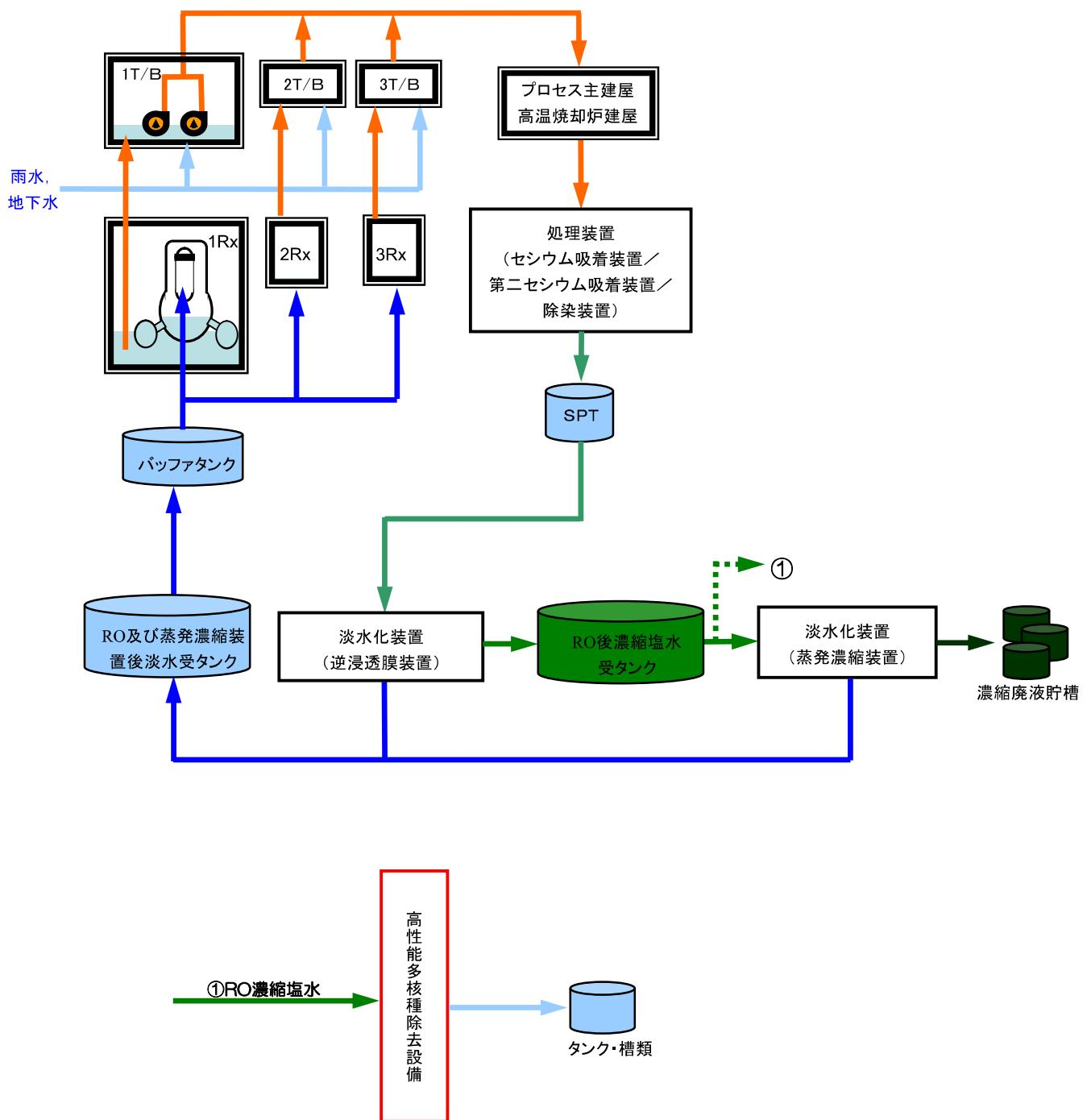
図－1 汚染水処理設備並びに高性能多核種除去設備等の全体概要図
