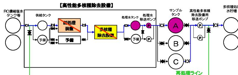
【STEP1 : 統廻復旧, サンプルタンクAからの再処理ラインに切替】
