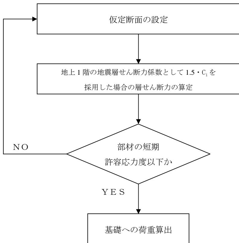
図－5 上屋から基礎への荷重算出手順
