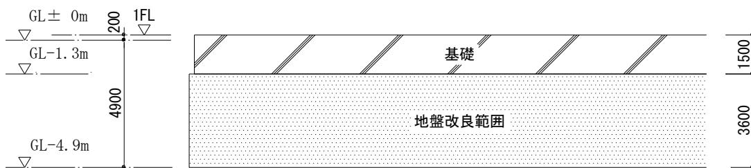
図-5 地盤改良範囲断面図
