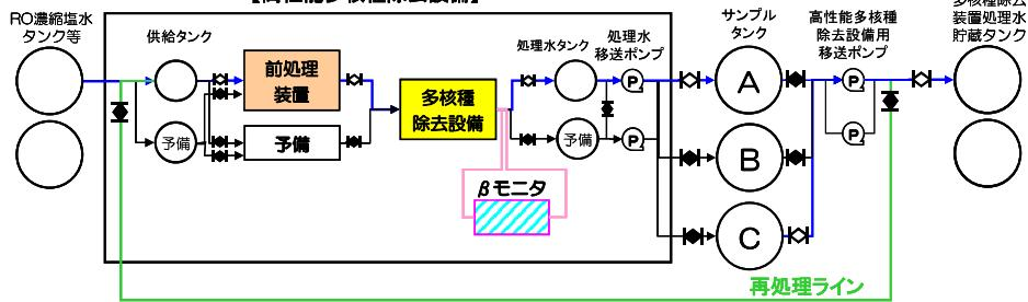
図3  $\beta$ モニタシステムの概要
