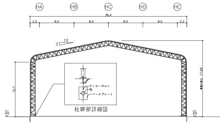
図-4 南北方向断面図（単位：m）
