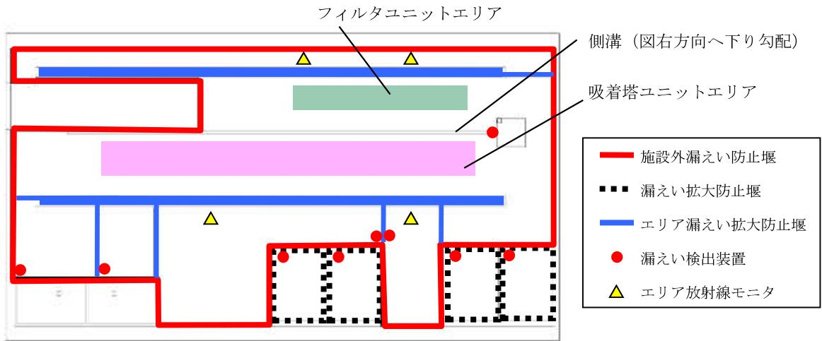
図 1 壁及び漏えい検出装置等の配置概要（上から見た図）
