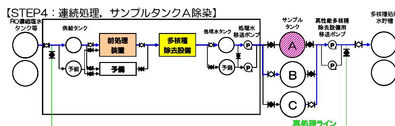
図 2 汚染発生時の対応ステップ (1 / 2)
