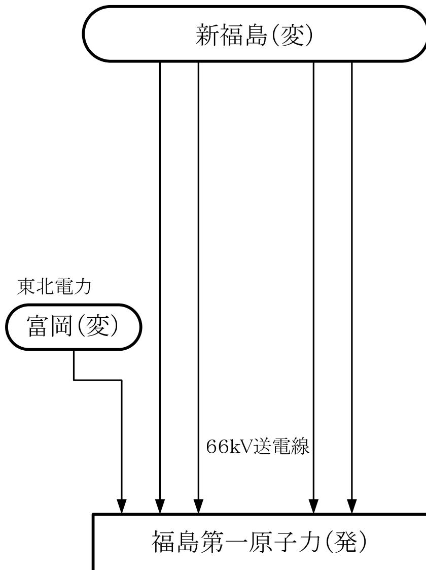
図－1．送電系統一覧図
