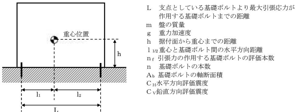
ボルトに作用する引張力 :  $F_b = \max [F_{b1}, F_{b2}]$
