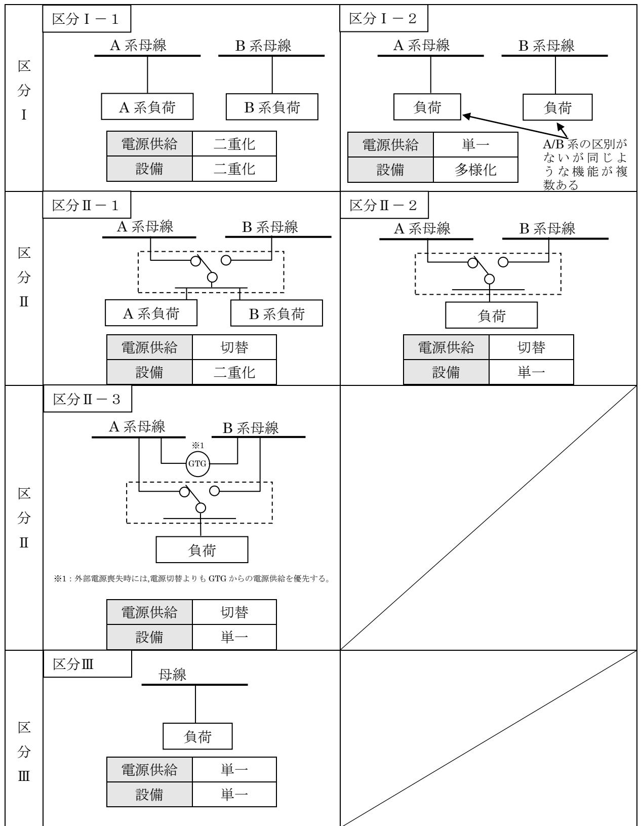
図-1 電源設備設計に関する区別概要単結
