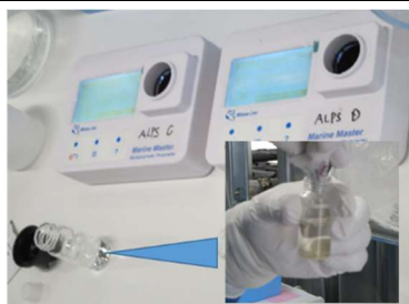
飼育水をセルに採取し、セルに試薬を添加
