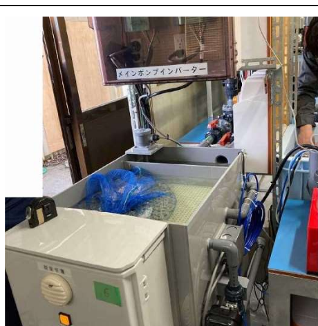
飼育訓練水槽に組み込んだ脱窒槽
