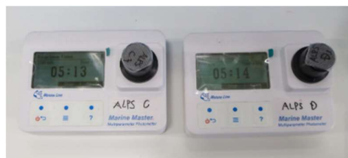
決められた時間静置 (計測器に時間が表示されます)
