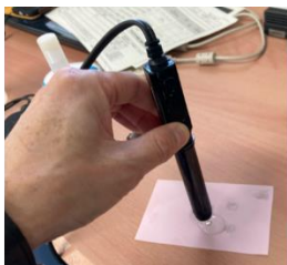
研磨フィルムで白金センサ 表面の被膜を除去
