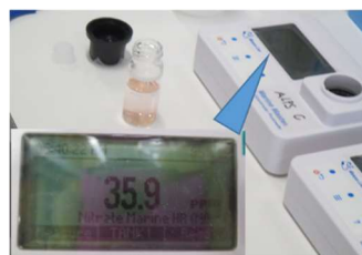
硝酸濃度に応じて発色 (計測値は35.9mg-NO 3 /L)
