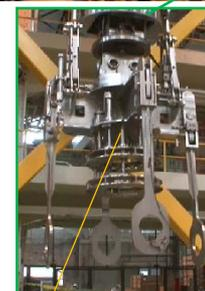
主巻フックに取り付けた垂直吊具で構内用輸送容器を吊り上げる。
