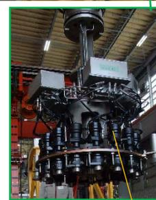
補巻先端に接続した構内用輸送容器蓋締め装置で蓋を締める。
