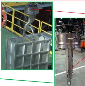
補助ホイスト先端にフック形状のツールを接続し、バスケットを吊り下げて、マニピュレータでつかんだガレキを回収。
