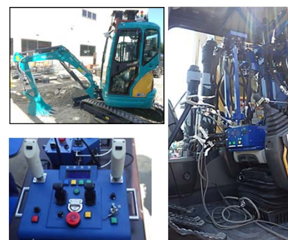
⑦遠隔操作重機 (集積)
