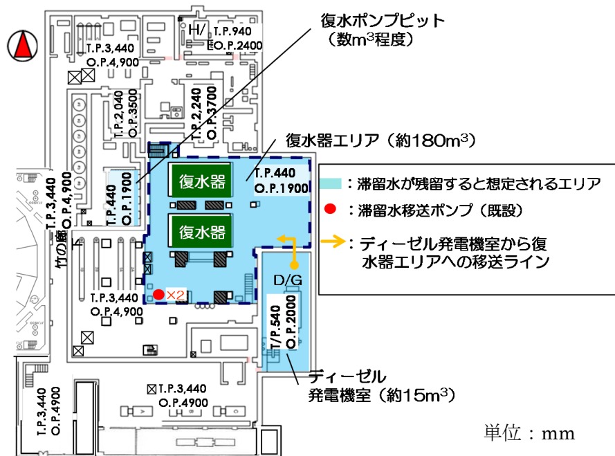
図-1 1号タービン建屋で最低排水レベルまで移送した場合の建屋内滞留水の残水量 (2016年2月現在)
