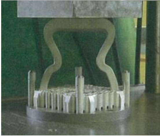
ハンドルを変形させる試験
