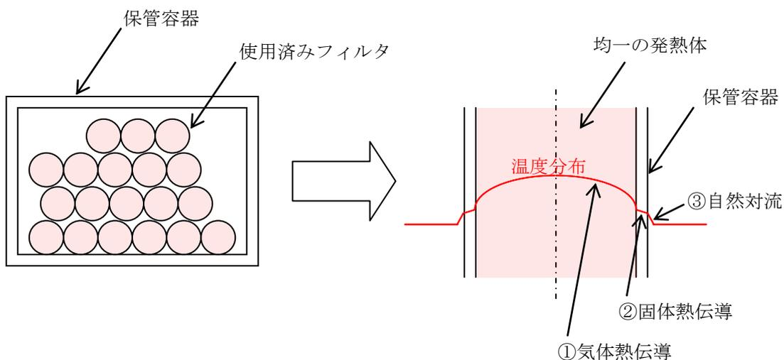
図-1 前処理フィルタの評価体系概念図（一次元定常温度評価モデル）
