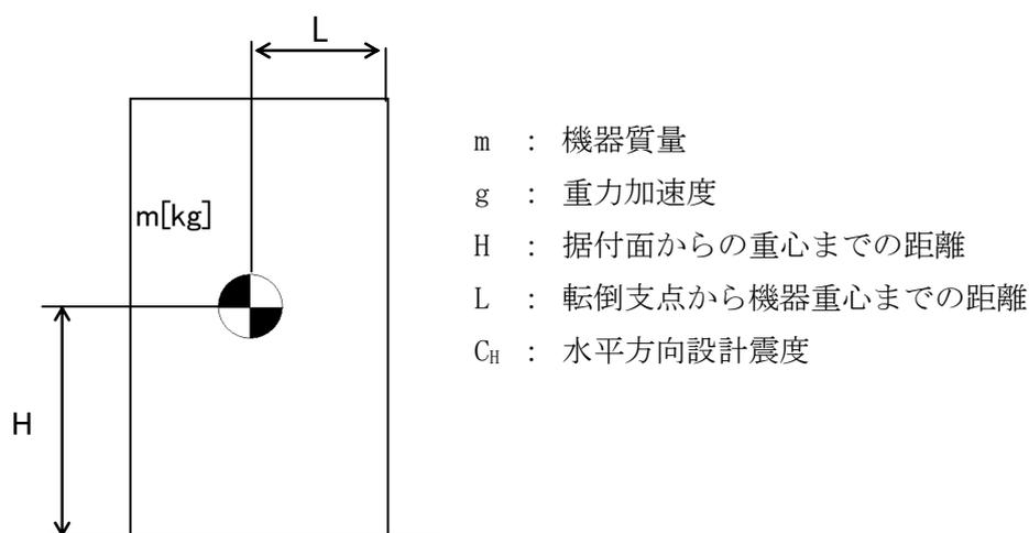
地震による転倒モーメント： $M_1[\text{N} \cdot \text{m}] = m \times g \times C_H \times H$
