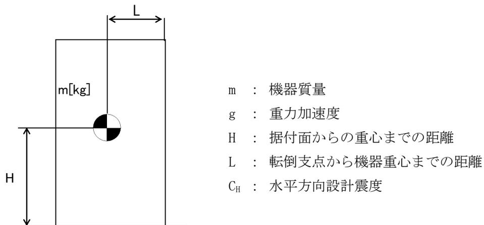
地震による転倒モーメント :  $M_1 [N \cdot m] = m \times g \times C_H \times H$
