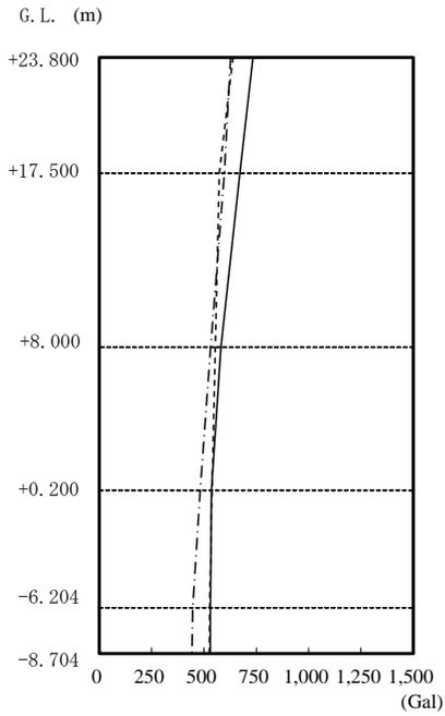
図 5 - 1 最大応答加速度
