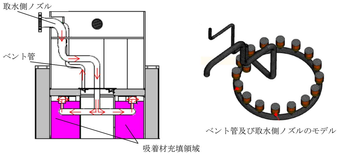
図1 多核種吸着塔の評価体系
