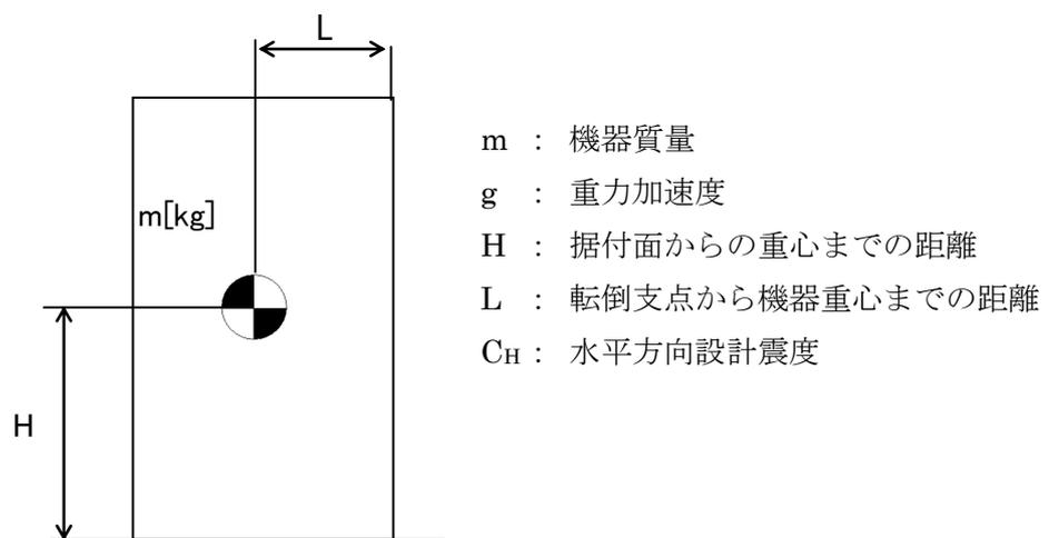
$$\text{地震による転倒モーメント} : M_1 [\text{N} \cdot \text{m}] = m \times g \times C_H \times H$$
