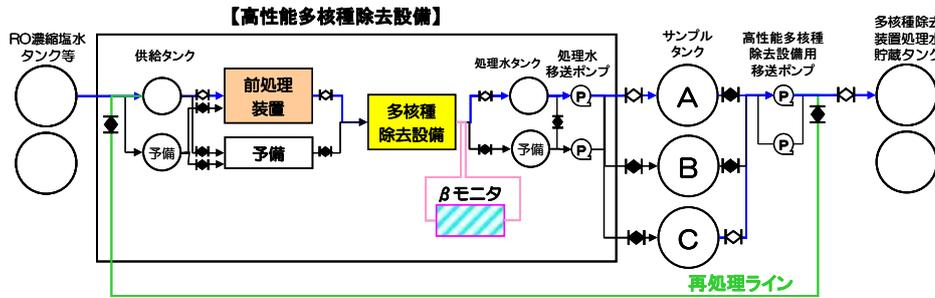
図3 βモニタシステムの概要
