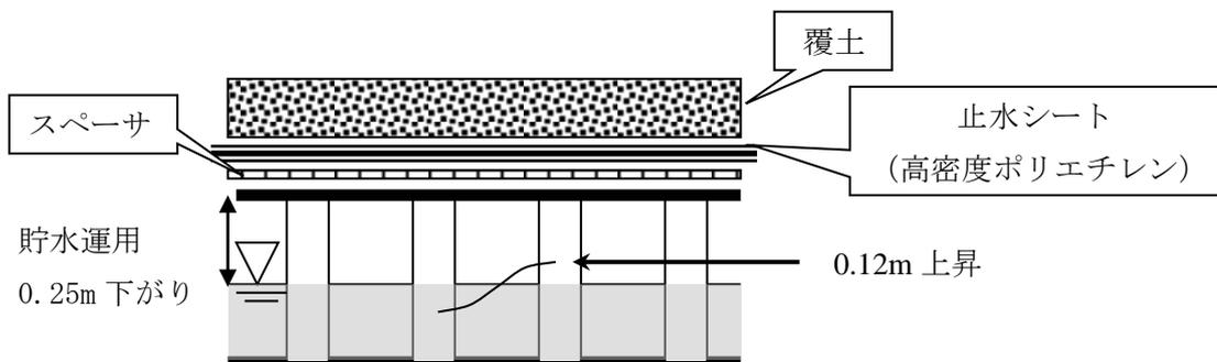
図-3 スロッシング時の水面変化
