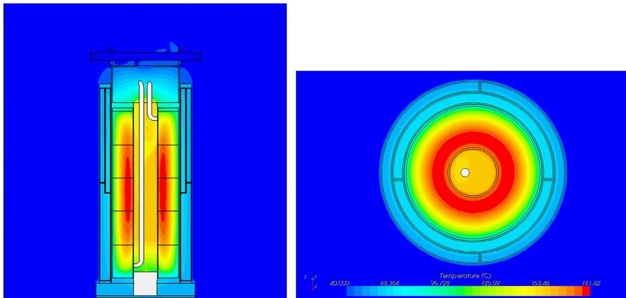
図4 吸着塔温度評価結果
