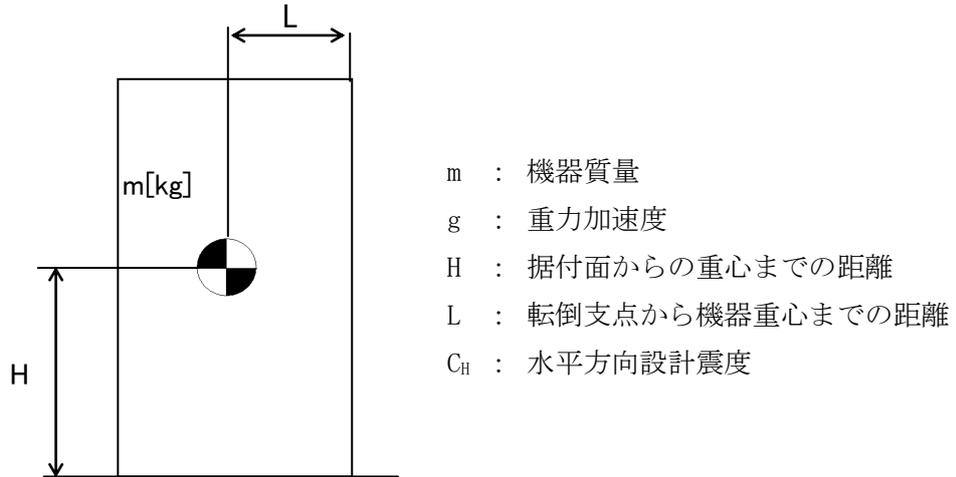
地震による転倒モーメント： $M_1 [N \cdot m] = m \times g \times C_H \times H$
