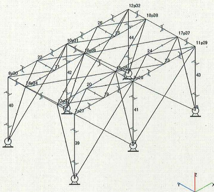
図-5 ディスクフィルタ解析モデル
