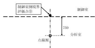
図-14 評価点⑨(非管理区域: 制御室)の計算モデル
