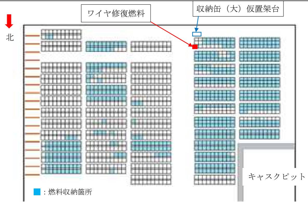
(a) 2号機使用済燃料プール内配置図
