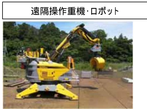
BROKK400D 主な役割 ・Warriorの移動 ・フェンスの切断・片付 等
