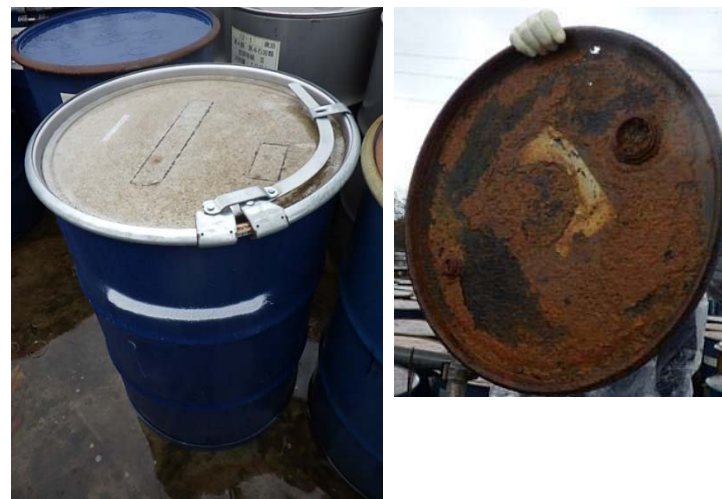
写真1. No.1A保管の当該ドラム缶(蓋交換後)と取り外した蓋
