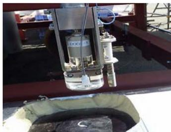
電解穿孔装置プローブ部
