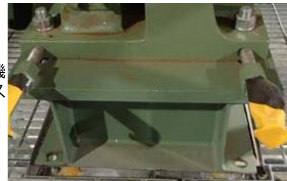
対策前(ボルト：径M12、材質：SS400、平ワッシャ使用)
