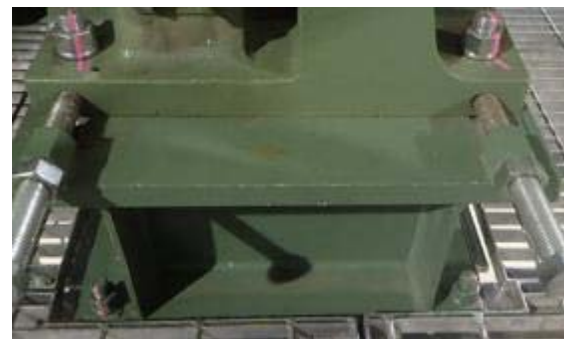
対策後(ボルト：径M20、材質：SNB7、テーパワッシャ使用)
