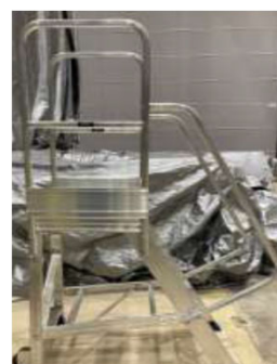
①作業階段（同様の型を撮影） 上部からフックを引っ掛けて、集積作業開始前に紐で吊り上げる予定
