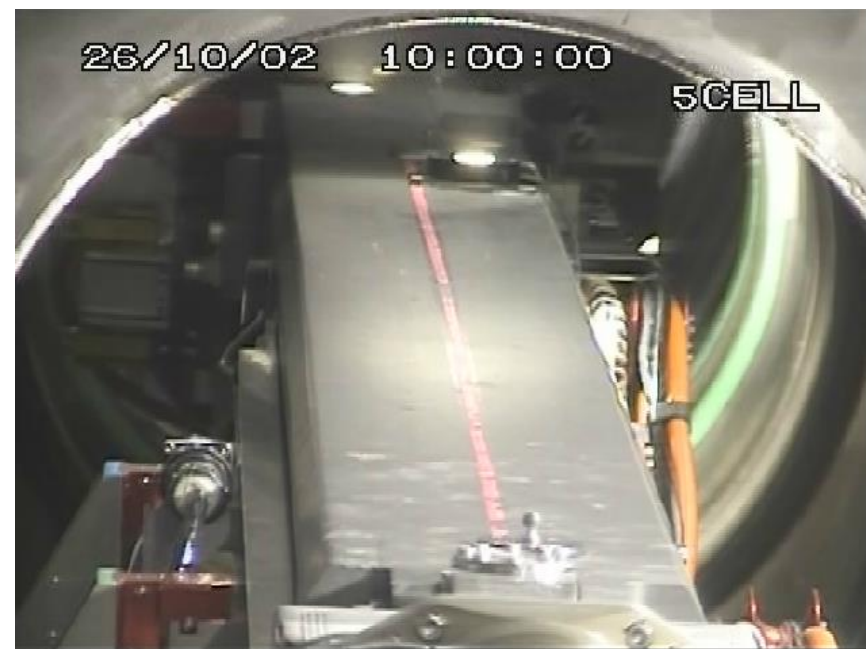
ロボットアームの先端が隔離弁を通過した状況（上部が隔離弁側） (エンクロージャ内カメラ)
