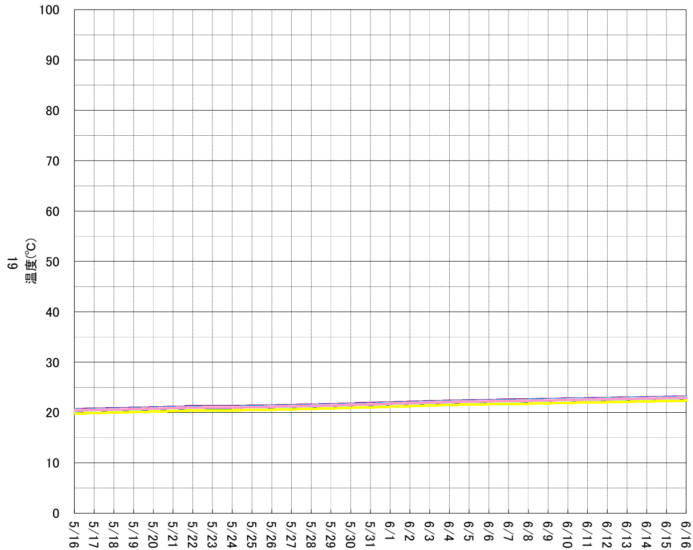
1号機 RPV周辺温度計(上部)
