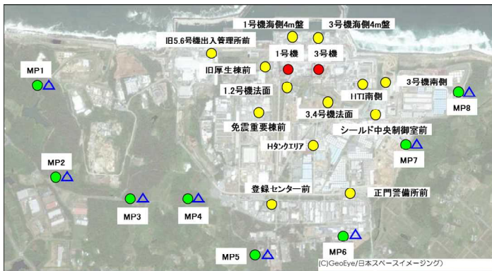
(参考1) モニタリングポストとダストモニタの設置地点
