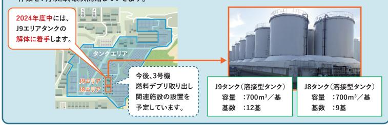
J8・J9エリアのタンク解体は、溶接型のタンクとしては初めての解体となるため、手順等を確認し知見を蓄えながら、安全最優先で作業を進めていきます。
