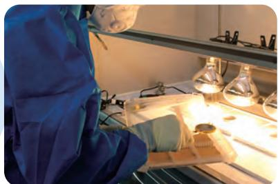
分析するための前処理として、全β放射能分析用の地下水を赤外線ランプで加熱している様子
