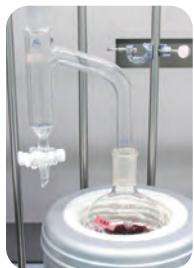
トリチウム分析用の地下水をヒータで加熱・蒸留している様子
