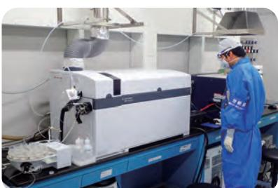
放射能分析のため誘導結合プラズマ質量分析装置を操作する様子
